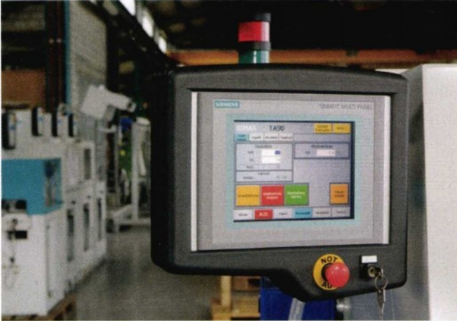
Das Simatic Multi Panel MP 277 mit der integrierten Soft-SPS Win AC ermöglicht die Steuerung und Überwachung auch komplexer Maschinen. Auffallend sind die grossen «Touch»-Flächen, dank welchen die Bedienung auch mit Handschuhen möglich ist.
