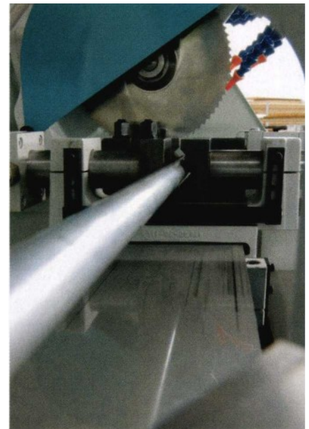
Zuschneiden mit wenig Resten: Beim Maschinentyp TA 91 CNC mit automatisch gemessenem Vorschub lassen sich verschiedene Teilleängen in einem Job zusammenfassen und unter optimaler Ausnutzung der Stangenlänge abarbeiten.
